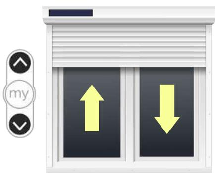
Au déballage du volet roulant, si nécessaire (installation dans la pénombre) éclairer le panneau solaire et appuyer simultanément sur les touches **MONTÉE** et **DESCENTE** du point de commande jusqu'au va-et-vient du volet roulant.
