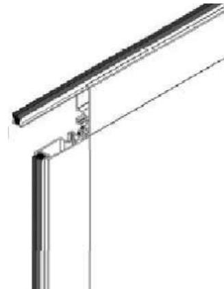
2. Assembler les 4 profils (B) avec les 4 équerres (C). Pour rappel, les brosses doivent être tourné vers l'extérieur.
