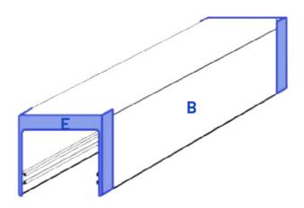
1. Insérer les caches du rail supérieur (E) de chaque côté du rail (B).
