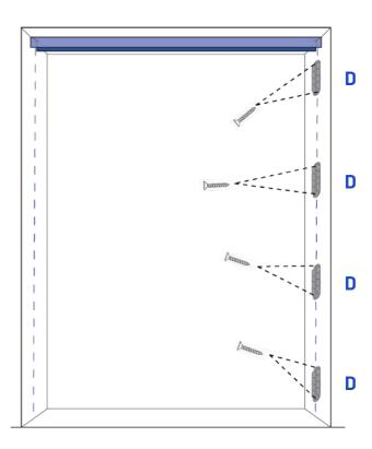
**5.** Sur le côté opposé, aligner verticalement les 4 autres plaques **(D)**\* et vérifier que celle-ci soit bien en face des autres. Puis, vissez et/ou collez les.
