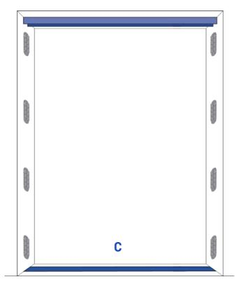
7. Placer le profil de réception aimanté (F) sur les plaques (D) et clipser les ensembles.
