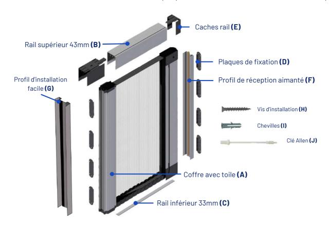
**0.** Nettoyer les surfaces d'installation et vérifier que tous les côtés sont d'aplomb à l'aide d'un niveau.
